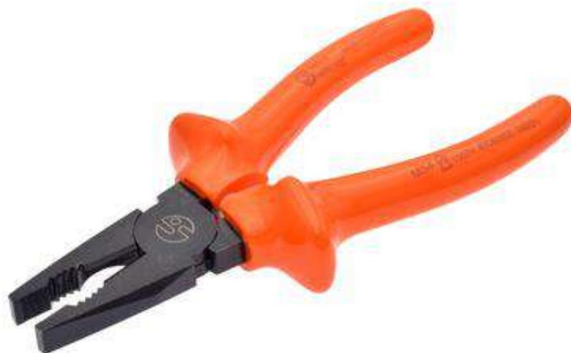
Alicate universal para cortar, sujetar y doblar diferentes elementos con o sin aislamiento. Con una capacidad de corte de hilo de acero 160kg/mm<sup>2</sup> : Ø 1,6 mm. Fabricado en acero al cromo-vanadio de alto rendimiento, con tratamiento por inducción, cuchilla de corte con dureza del filo: 60 HRC. Conforme a la norma la IEC 60900, fabricados bajo los requisitos técnicos de la NF ISO 5743 / NF ISO 5744 / NF ISO 5746. Origen francés.
