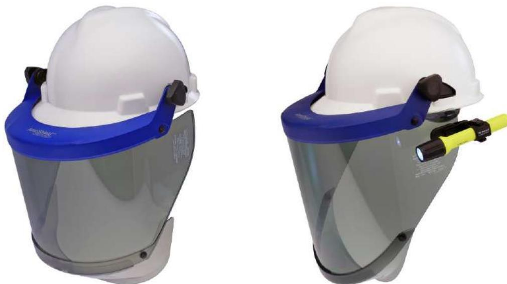
Careta protección facial arco eléctrico altamente transparente (HT™) con protector de barbilla transparente de perfil pequeño y soporte para cascos con ranuras. Probado a un ATPV de 12 cal/cm<sup>2</sup> según ASTM F2178 (Prueba de arco abierto). Cumple con NFPA 70E (HRC 2). Con revestimiento estándar. Casco no incluido.
